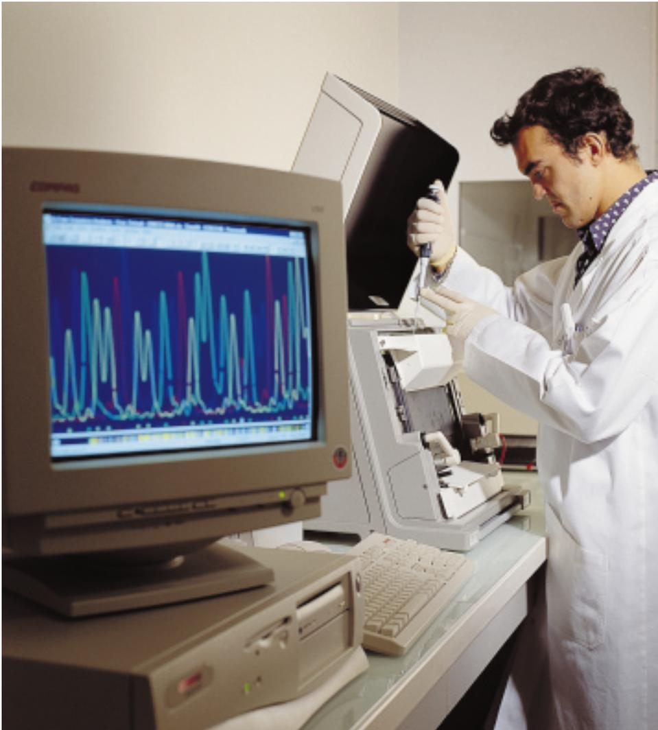
*Séquenceur automatique d'ADN. Le gel échantillon est introduit à l'aide d'une seringue dans le séquenceur. Chaque couleur sur l'écran correspond à une base d'ADN après analyse de la séquence.*
