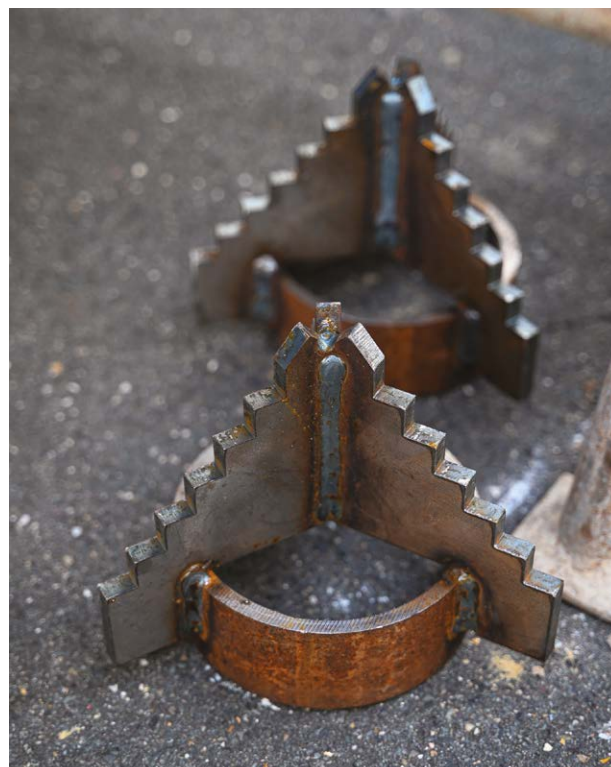
Pose de micro pieux destinés à l'ETCB (Enceinte de Traitement et de Conditionnement des déchets B) Têtes de forage. ©CEA-UADF
