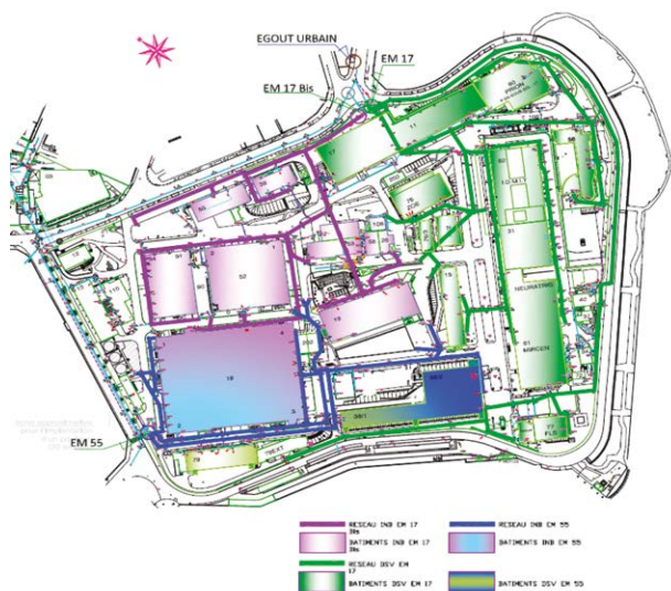
Figure n° 2 : Schéma des émissaires de transfert à l'égout urbain des effluents liquides du site CEA de Fontenay-aux-Roses.
