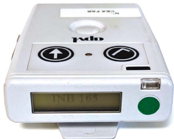
Le dosimètre actif (ou opérationnel) donne une information en temps réel lisible directement par le porteur.
