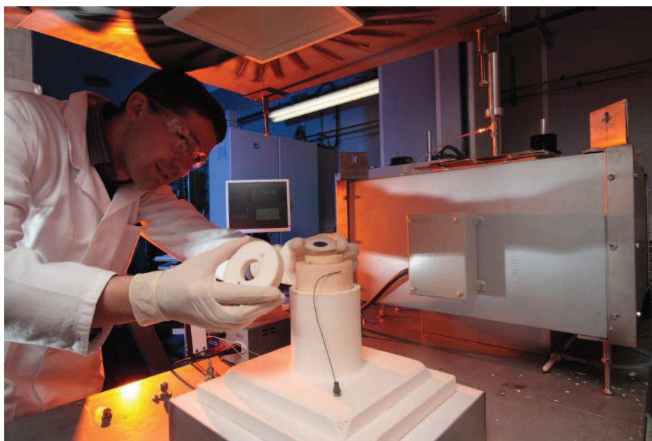
Image : Four servant aux tests de composants de cellules SOFC, à Grenoble. © P.Avavian/CEA
