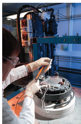
Image : un électrolyseur HT sur banc d'essais, sur le centre CEA de Grenoble. © P.Avavian/CEA
