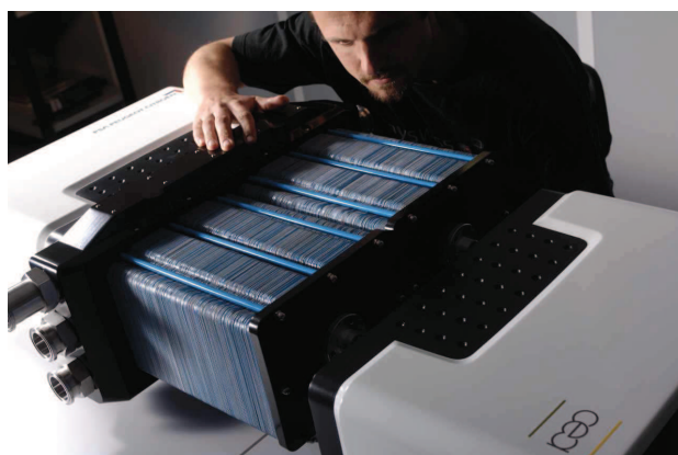
Image : la pile GENEPAC développée en 2006 avec PSA Peugeot-Citroën. © P.Stroppa/CEA
