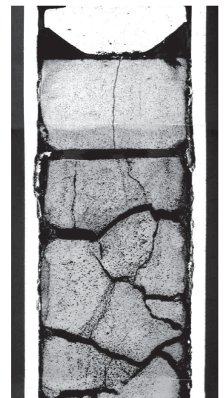
Fig. 111. Coupe métallographique axiale d'une corrosion à l'interface fissile-fertile (RIFF) sur une aiguille PHÉNIX à gaine en acier 15-15 Ti écroui irradiée à 13,3 at%, soit 115 GWj/t ox .
