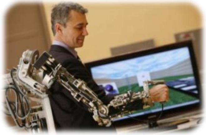
d'actionnement à haut rendement permettant de commander le bras en effort sans capteur de force.
