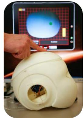
2. Console centrale d'un véhicule à retour d'effort : technologie reprogrammable brevetée basée sur l'utilisation de fluides magnétorhéologiques pour améliorer la navigation dans les menus en exploitant le sens du toucher.
