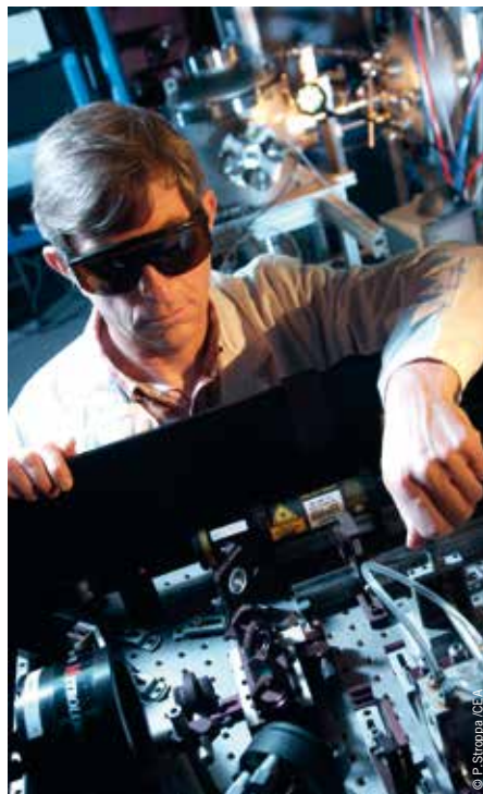
Réglage d'un laser à solide pompé par diodes de forte puissance, utilisé pour générer la lumière extrême UV (13,4 nm) pour des applications de photolithographie.
