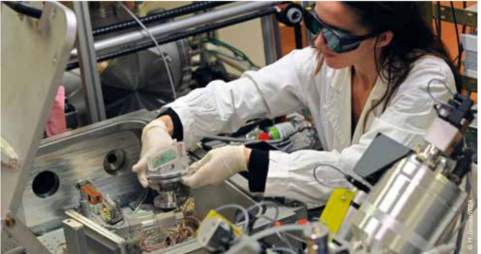
Mise en place de composants optiques d'un laser sur la Plate-forme Laser Femtoseconde Accordable (PLFA).
