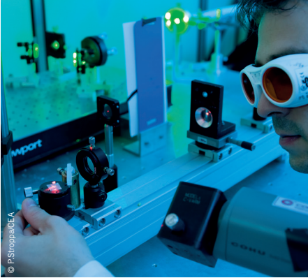
Etude des variations induites dans les matériaux lasers par pompage optique.
