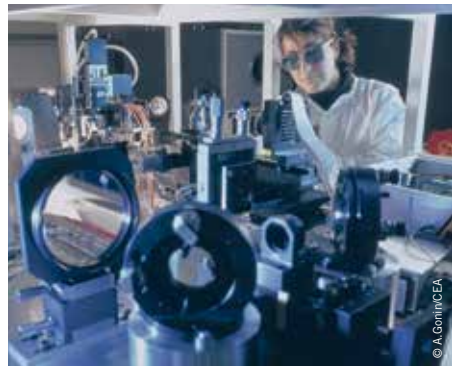
Maquette 1/5 de la chaîne laser de la Ligne d'intégration laser (LIL). Elle a permis de développer des logiciels d'alignement systémique des divers éléments (amplificateurs, miroirs...).
