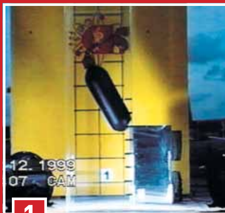
Essai de chute de 14 m d'un réservoir de dihydrogène sous haute pression.
