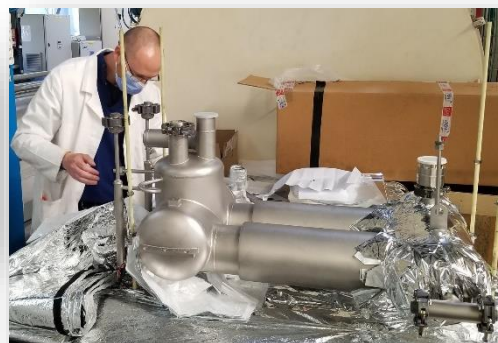
Figure 2 : Vue extérieure de l'échangeur avant essais dans la station de tests à 1,8 K de l'Irigr.
