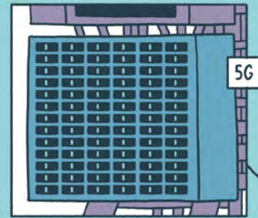
Dispositif avec des centaines de mini-antennes pour les très hautes fréquences (26 GHz).
